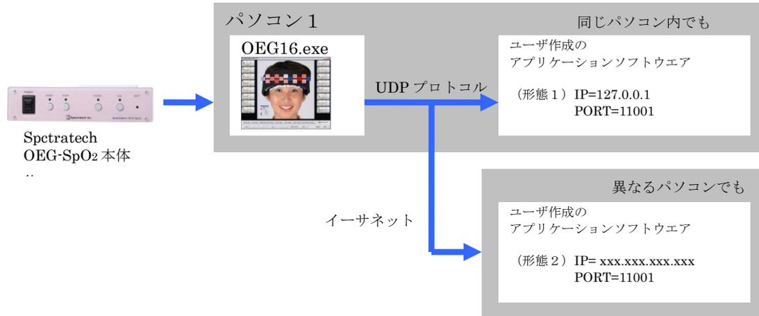
UDP(User Datagram Protocol)とは、インターネットで利用される標準プロトコルの一種で、OSI 参照モデルのトランスポート層にあたります。インターネットでは、一般的にトランスポート層のプロトコルとして TCP が使われますが、UDP も今回の弊社での利用形態のようなリアルタイム性が要求されるストリーミング等で広く利用されています。
